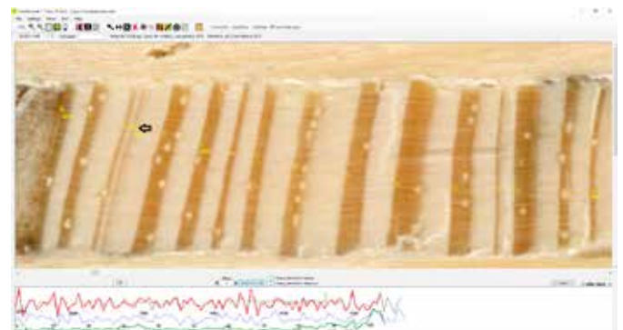
Fig. 9. Corectarea măsurătorii prin introducerea inelului nemăsurat
