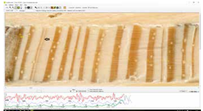
Fig. 8. Instantaneu din CooRecorder a măsurătorii unei carote (linia roșie) comparativ cu referința (linia neagră)
