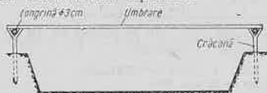
Fig. 5. Așezarea umbrarelor pe longrine și crăcane.
